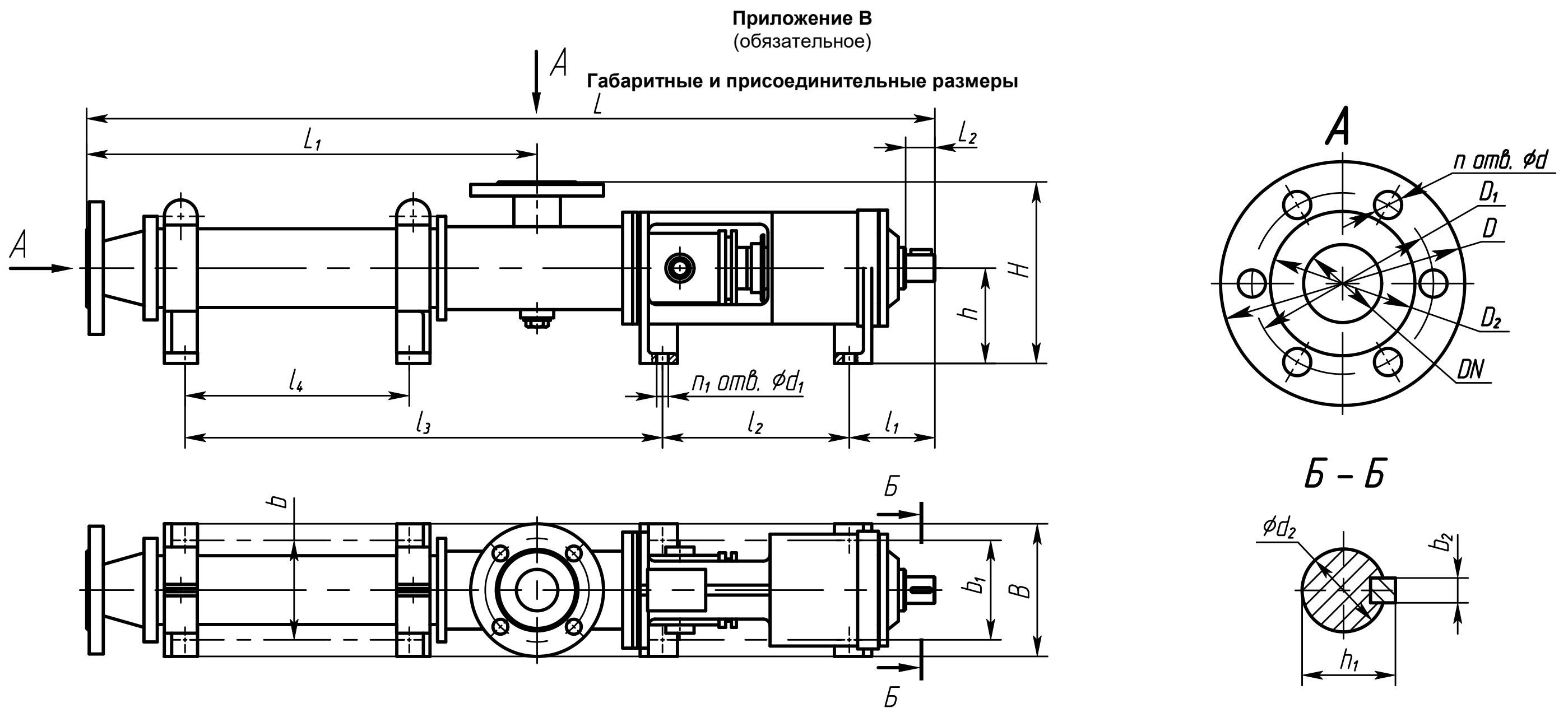
Рисунок В.1 - Габаритные размеры насосов
