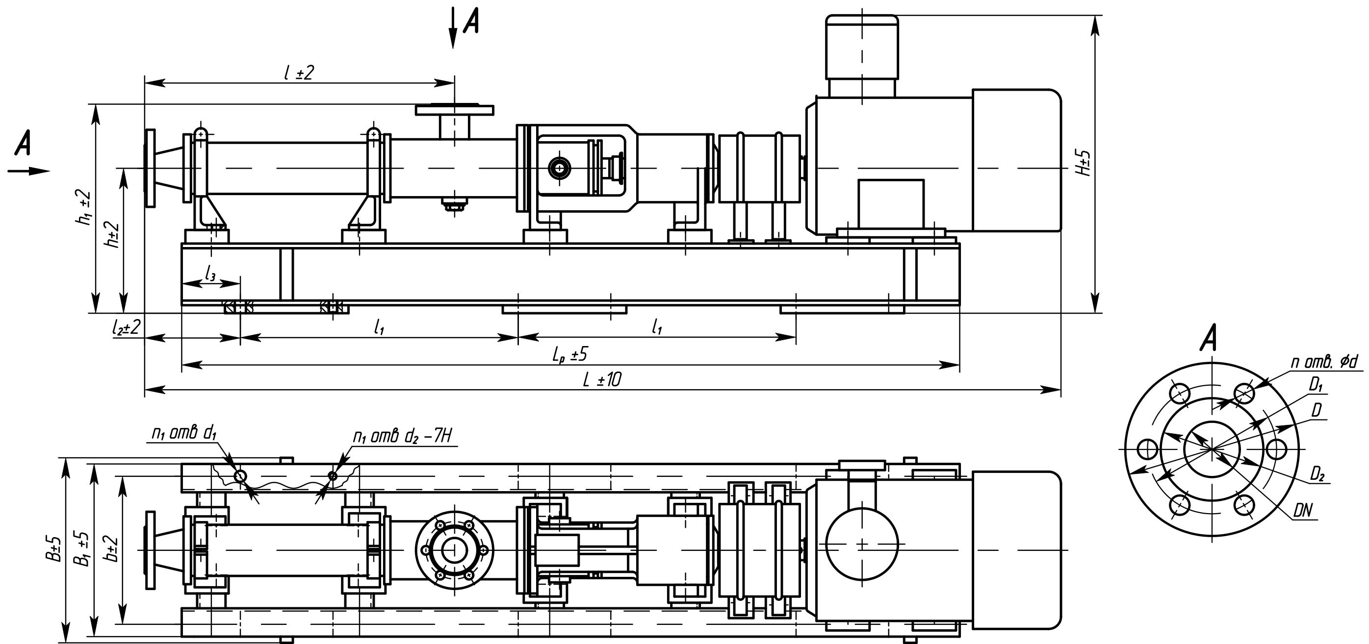
Рисунок В.2 - Габаритные размеры агрегатов в комплектации с электродвигателем.
