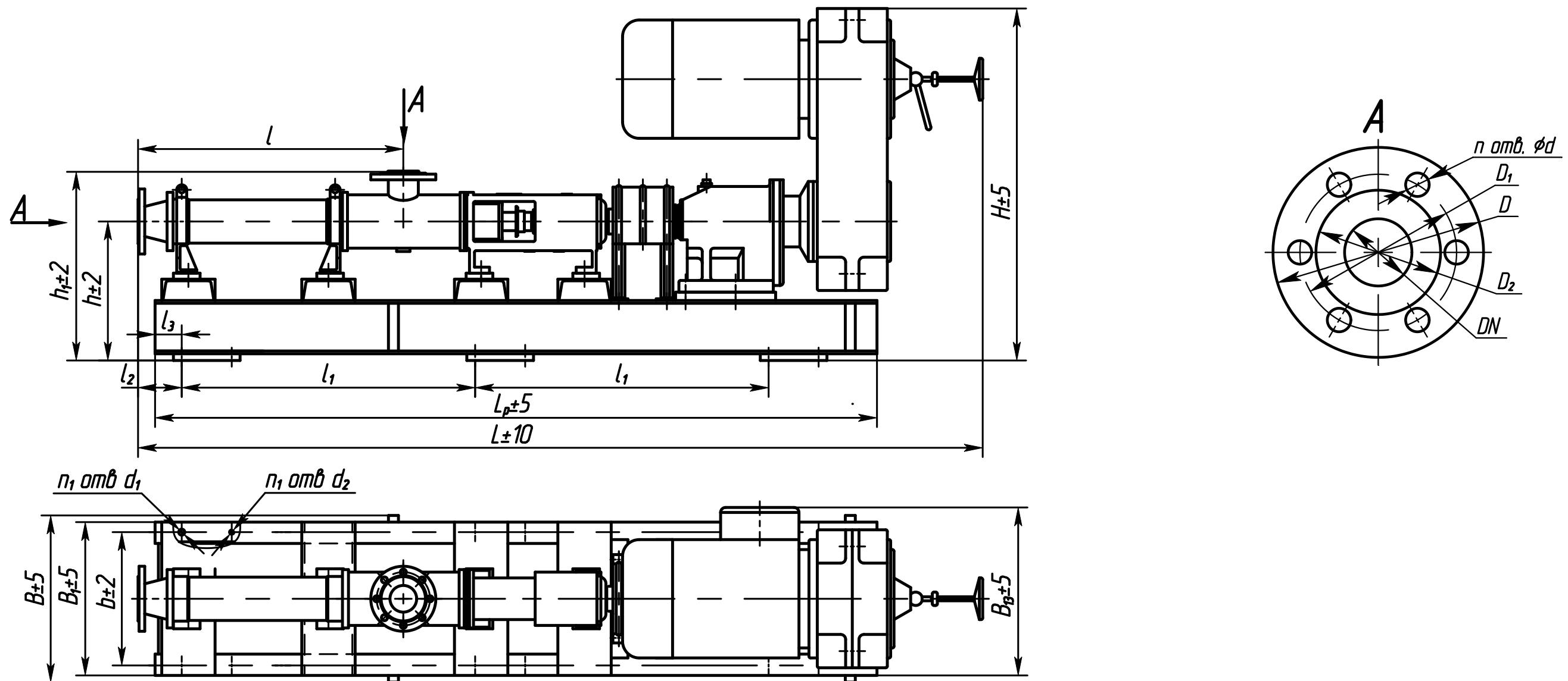
Рисунок В.6 - Габаритные размеры агрегатов в комплектации с мотор-вариатор-редуктором фирмы NORD.
