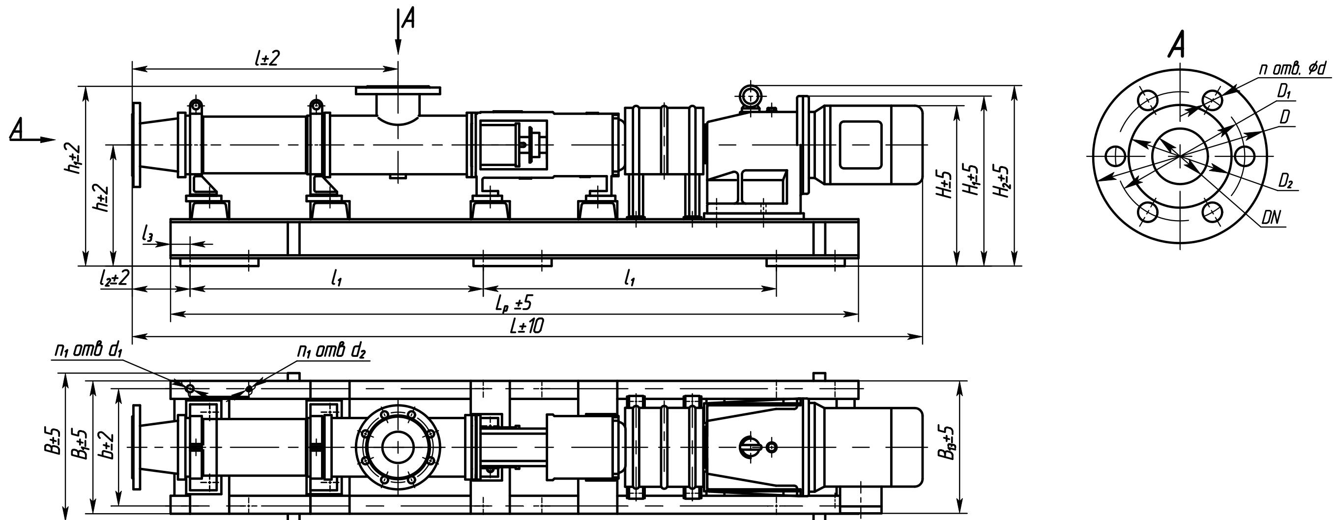
Рисунок В.5 - Габаритные размеры агрегатов в комплектации с мотор-редуктором фирмы NORD.
